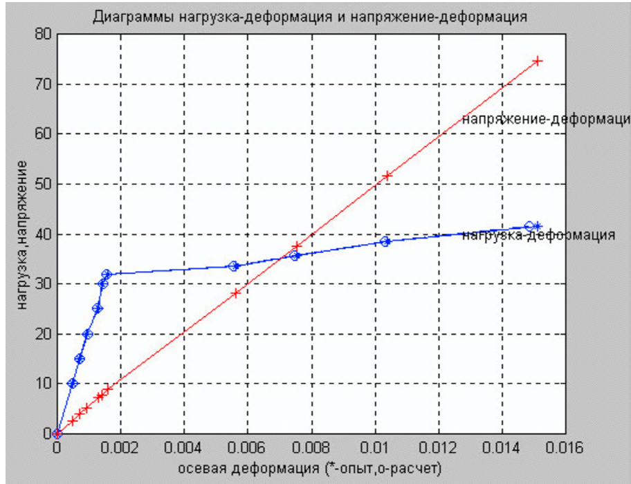
Рис. 2: Диаграммы: нагрузка-деформация, деформация, напряжение-деформация (сталь 30).
