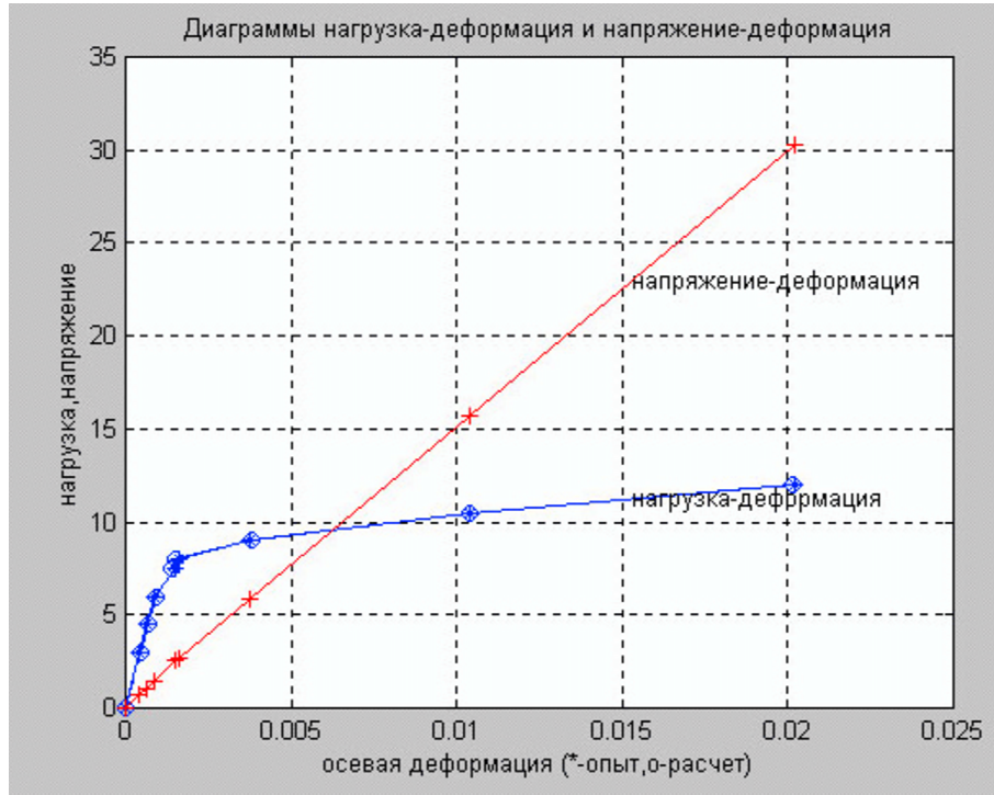
Рис. 3: Диаграммы: "нагрузка-напряжение-деформация" (алюминий).
